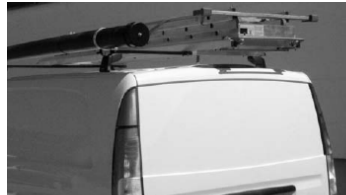
Ladungsrohr und Leiterlift
